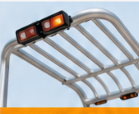
OŚLONA DACHOWA Z OŚWIETLeniem
